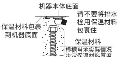
注：在寒冷地区，建议在配管上先进行电加热防冻设置后再包裹保温材料。
