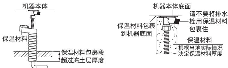
注：在寒冷地区，建议在配管上先进行电加热防冻设置后再包裹保温材料。
